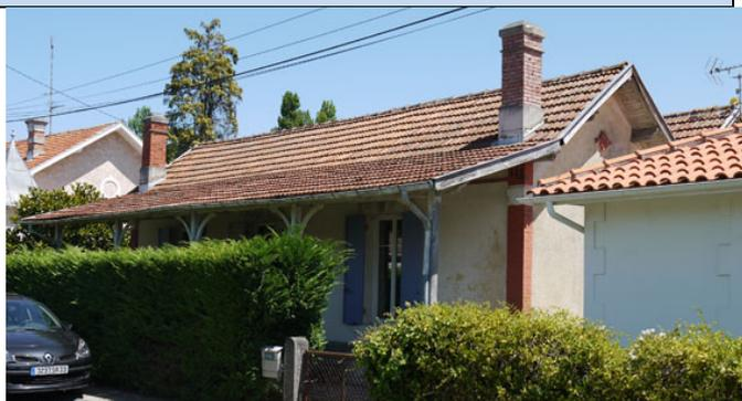
**Particularités :** La toiture, couverte de tuiles de Marseille, est composée de deux faîtages parallèles à la rue, qui délimitent quatre pans sur deux versants. La galerie en façade s'insère sous une rupture de pente de la toiture. Le toit est maintenu par des piliers en bois et des jambes de force arquées. La brique est utilisée pour composer les souches de cheminées et les retours d'angles. Des moulures soulignent les ouvertures en façade. Une haie dense dissimule en grande partie la façade.
