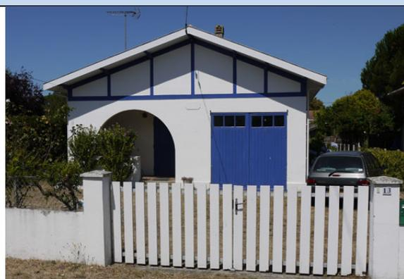
**Particularités :** La façade possède une architecture de type basque. Les murs sont couverts d'un enduit blanc. Le pignon est caractérisé par une charpente apparente, peinte de couleur vive, ainsi que par une dissymétrie des deux pans. Les débords de la toiture sont soutenus par des éléments de charpente apparents. Le mur pignon possède une grande ouverture arquée du côté du pan long, qui ouvre sur un perron abrité.
