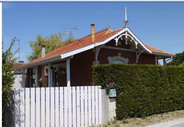
**Particularités :** La villa se situe à l'angle de deux rues. La toiture à 3 pans, composée de tuiles de Marseille, est surmontée d'une crête faîtière et de deux épis en terre cuite. Les deux façades côté voirie sont valorisées par des retours de pignon à larges débords, au dessus d'une fenêtre. Les débords sont ornementés par des éléments de charpente et par des jambes de force, peints et sculptés. Un grand épi en bois peint marque l'extrémité du faitage de chacun des retours.
