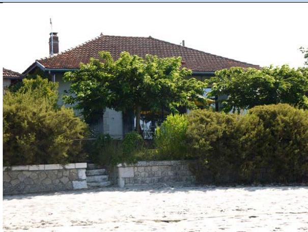
**Particularités :** La galerie est soutenue par des colonnettes de fonte. La toiture est couverte par des tuiles de Marseille. La souche de cheminée est composée d'un assemblage de briques. La façade littorale est en grande partie masquée par les plantations du jardin.
