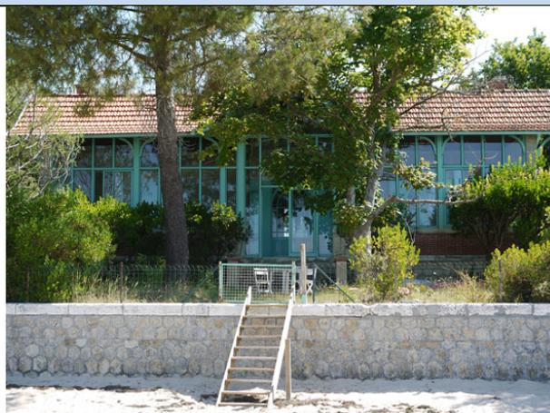
**Particularités :** La façade littorale accueille une galerie à verrière avec retour de toiture central. La verrière est le motif architectural principal de la façade. Les débords de toiture latéraux sont soutenus par des jambes de force arquées et sculptées. La toiture est recouverte de tuiles de Marseille. Le jardin compte un certain nombre d'arbres participant au front boisé du littoral.
