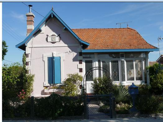
**Particularités :** La toiture, en tuiles de Marseille, est surmontée d'épis de faitage. Les débords de ses pans sont recourbés. Sur le pignon, les débords sont tenus par des éléments de charpente apparents, peints du même bleu que le bandeau et les volets en bois. Une véranda au vitrage mousseline ancien, tenues par des éléments de charpente moulurés, s'abrite derrière le retour de pignon. Un perron en permet l'accès.
